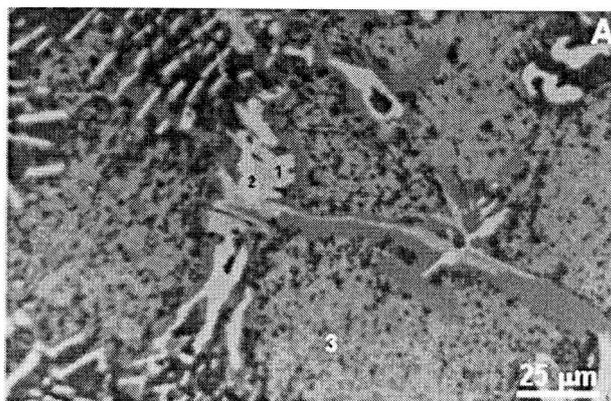
Рис. 38. Микроструктура верхней части слитка 15Fe-85Pr, полученного направленной кристаллизацией (1 мм/мин). Очевидно образование соединения  $PrFe_2$  по перитектической реакции: 1 – фаза  $PrFe_2$ ; 2 – фаза  $Pr_2Fe_{17}$  и 3 – первичные кристаллы (Pr) [139].
