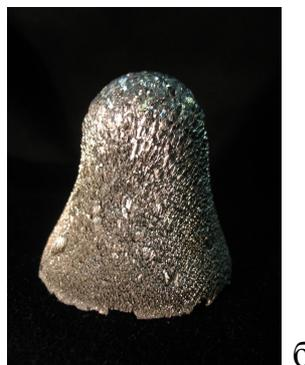
Рис. 1. Схема печи для дистилляции редкоземельных металлов (а) и внешний вид получаемых дистиллятов (б).
